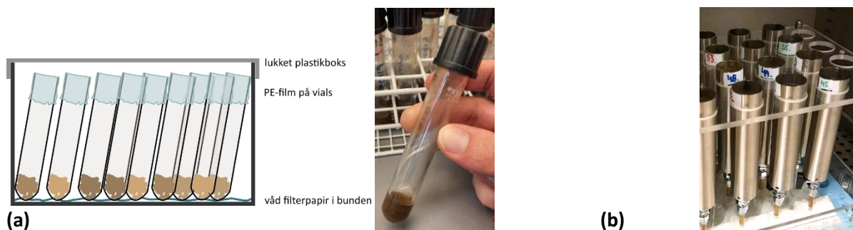
Figur B2. Forsøgsopsætning til batch-nedbrydningsforsøg og jordsøjler (a) batch-nedbrydningsforsøg med cyazofamid og DMS og (b) søjleforsøg til undersøgelse af udvaskning af DMS og DMSA fra cyazofamid.
