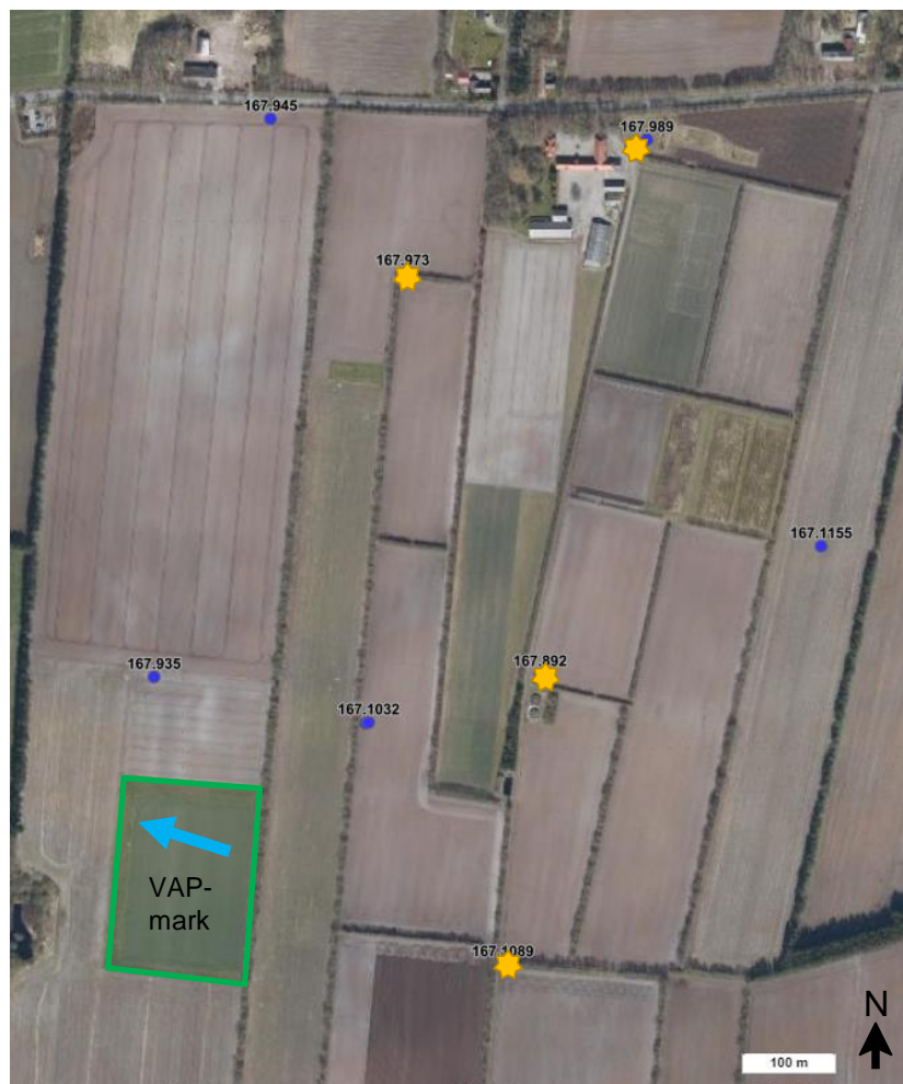
Figur 10. VAP-marken i Jydevad med omkringliggende marker. Gule stjerner markerer beliggenheden af de 4 markvandingsboringer. Fra nord til syd er det DGU-boring 167.513, 167.973, 167.892 og 167.1089. Blå pil markerer grundvandets generelle strømningretning.
